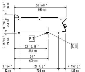
Electrical inlet (power) FΩ **Equipotential screw**
